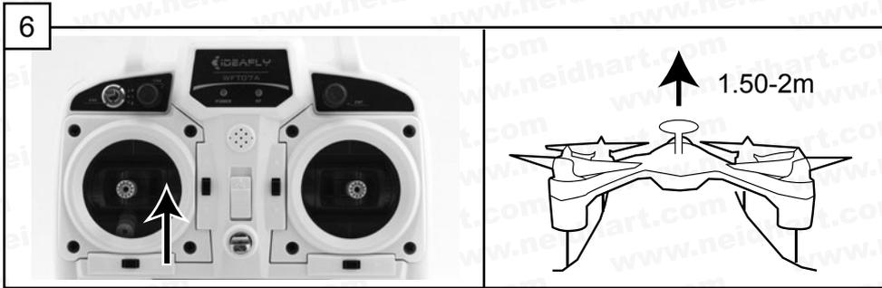
Sobald die Motoren drehen, bewegen Sie den Steuerknüppel langsam nach oben, bis ca. 50%. Das Modell steigt automatisch auf eine Höhe von 1.5-2m.
