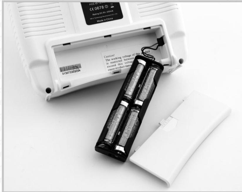
Der Sender funktioniert mit einer Spannung von 3.7V bis 6V, die aktuelle Spannung kann am Bildschirm des Modells abgelesen werden und ein akustischer Alarm informiert über eine zu tiefe Spannungslage.
