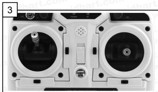
Führen Sie den linken Steuerknüppel auf Maximalposition (oben).
