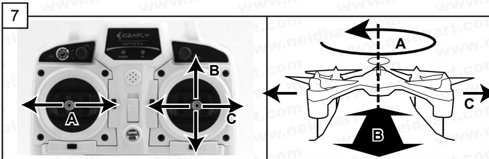
Verändern Sie die Höhe nicht mehr, sondern verwenden Sie die anderen Lenkbefehle, um das Modell zu steuern und bewegen.
